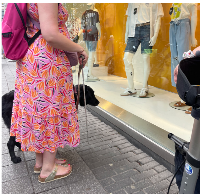
Losse tegels/met grote voegen aan de etalages zijn nefast voor blinde personen. Het zou goed zijn als de randen van de etalages gelijk worden getrokken.
